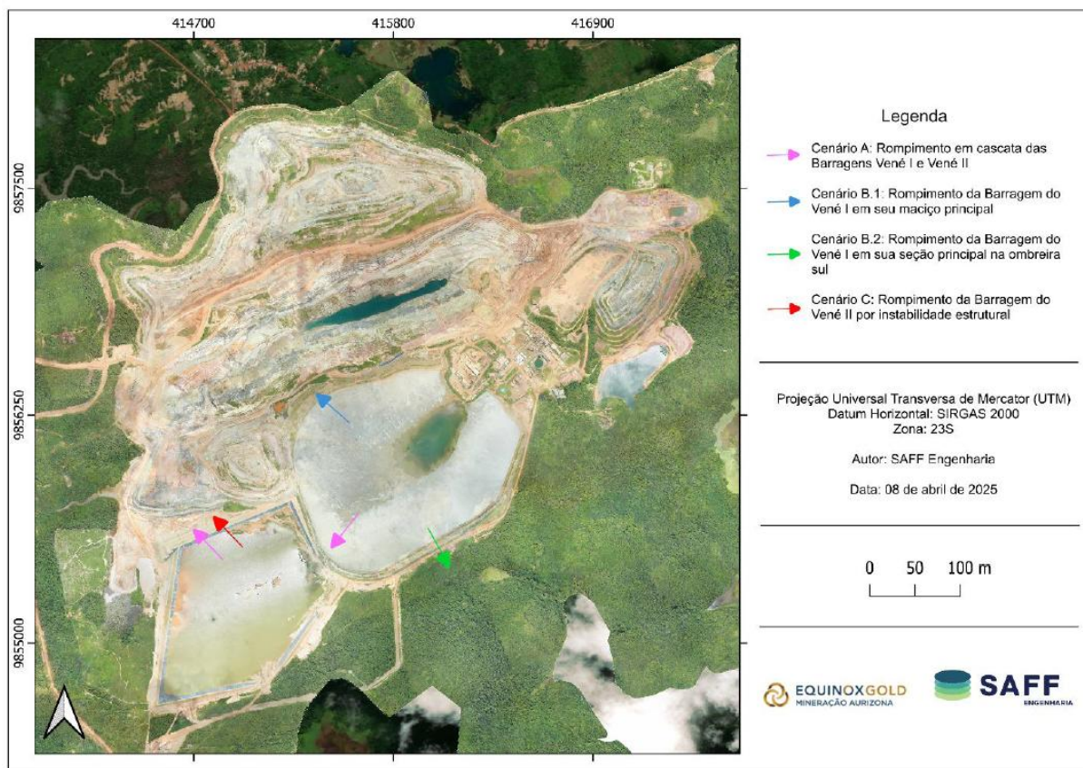
Figura 04 Representação Esquemática da posição da Brecha para simulação de Ruptura Hipotética da Barragem do Vené I para os Cenários A, B1 e B2
